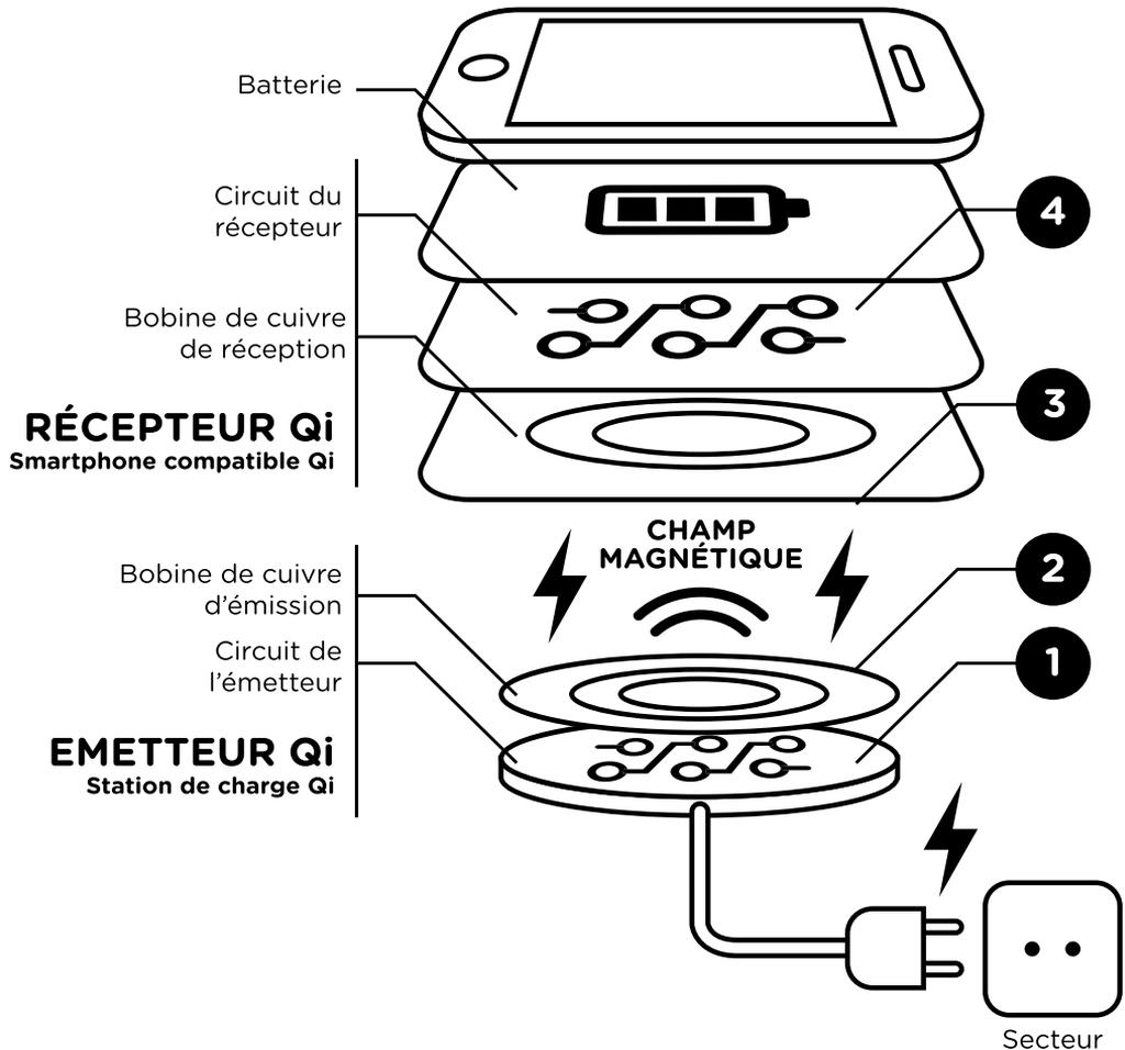
**1** Le circuit émetteur transmet le courant à la bobine de l'émetteur..
